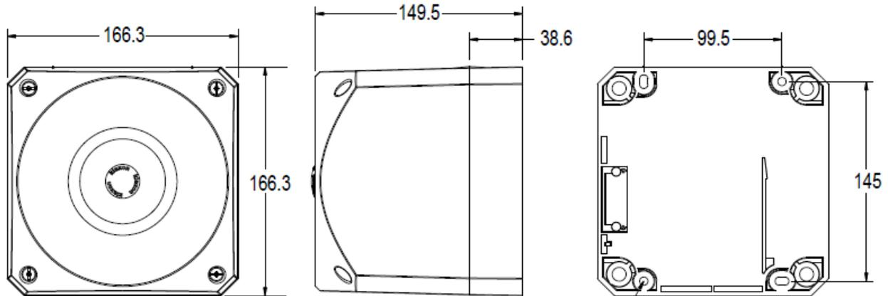
Trous de fixation diamètre 6 mm
