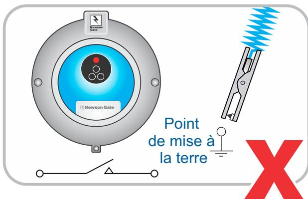
**C.** Si la connexion entre le camion-citerne et la terre est interrompue au cours de l'opération de transfert la DEL **rouge**, indiquant l'absence de raccordement à la terre, s'allume et les contacts d'interverrouillage s'ouvrent.
