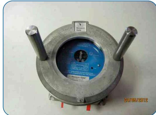
Placer les clavettes de couvercle dans les deux orifices de couvercle du boîtier métallique ER11.
