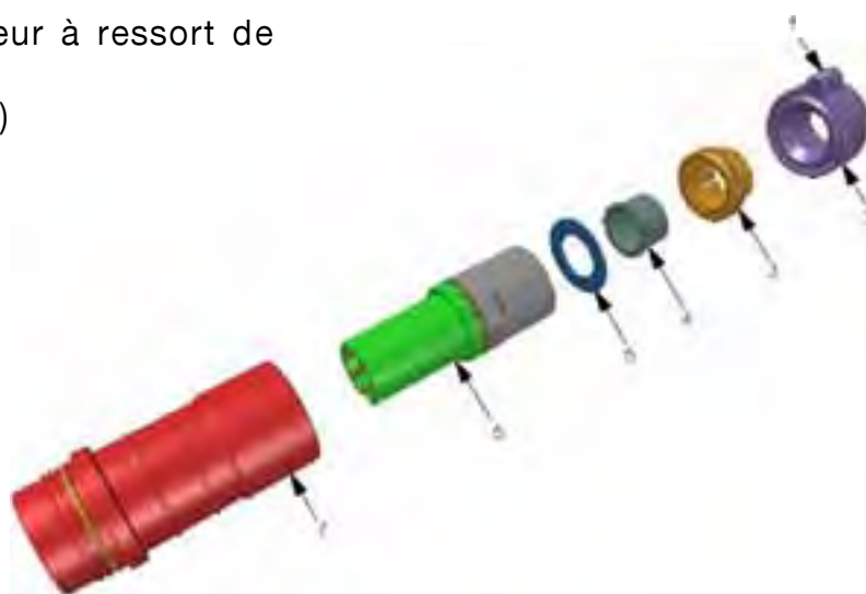
Fig. 13-1 prolongateur à ressort de rappel en cage
