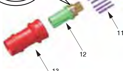
Fig. 15-1 coupler du connecteur pour câbles armés
