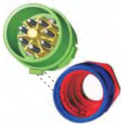
Fig 9.3 Montage du socle connecteur
